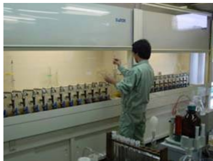
浄水工程の採水
